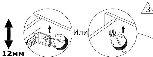
**4. Отрегулируйте положение тумбы по уровню, используя верхние регулировочные винты навесов.**
